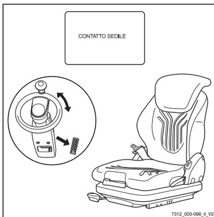
Il dispositivo di comando per l'impianto idraulico di lavoro viene azionato senza azionare l'interruttore sedile
