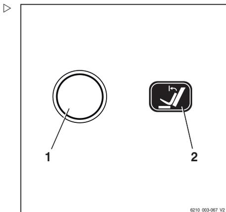
Il montante di sollevamento viene inclinato in avanti e si ferma non appena viene raggiunta la posizione verticale. La freccia presente sopra la barra mostrata nell'unità di comando e display indica la « posizione verticale del montante di sollevamento ».
