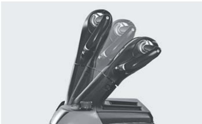
Sterzo regolabile in altezza a seconda dell'altezza del conducente<sup>1</sup>
