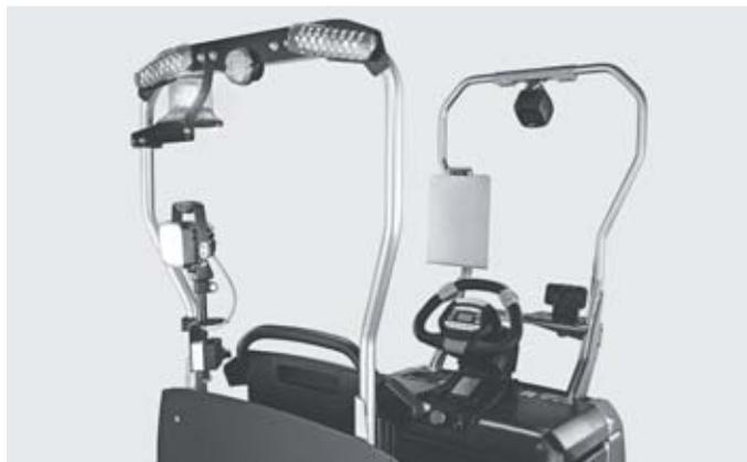
Staffa per accessori opzionali per molteplici possibilità d'uso e varianti di dotazione con lampeggiante e fari di lavoro<sup>2</sup>
