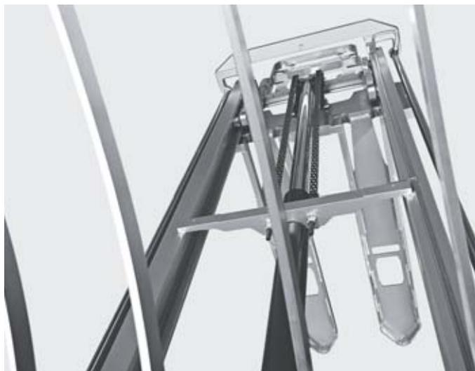
Visuale ottimale delle punte delle forche per una capacità di movimentazione elevata e un'agevole inforatura dei pallet
