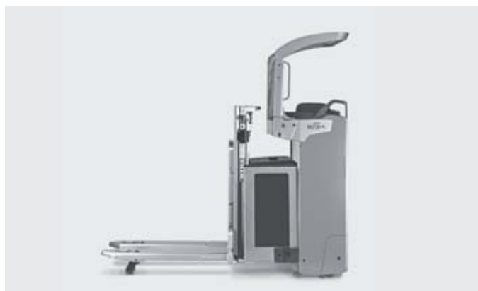
Velocità di movimentazione elevata: fino a 2.000 kg di portata e alla velocità fino a 12 km/h
