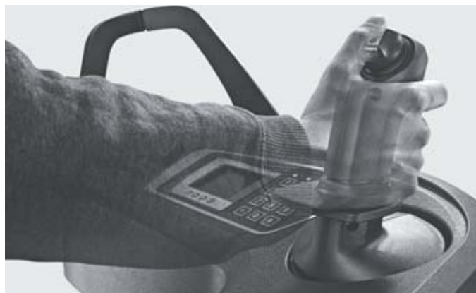
Guida, sollevamento e abbassamento precisi con il joystick di serie, senza dover cambiare mano
