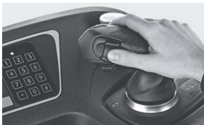
Joystick 4Plus opzionale per il sollevamento, l'abbassamento e il controllo trazione senza dover cambiare mano
